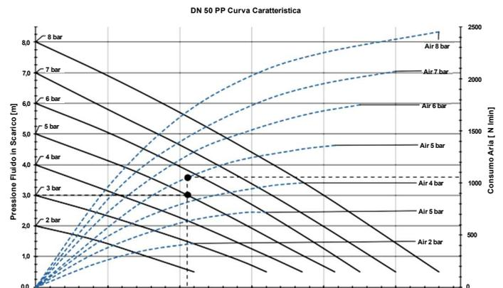
Per pompare 110 l/min ad una pressione di 4 bar, si richiedono di 8 bar di alimentazione con consumo d'aria di 820 Nl/min.
