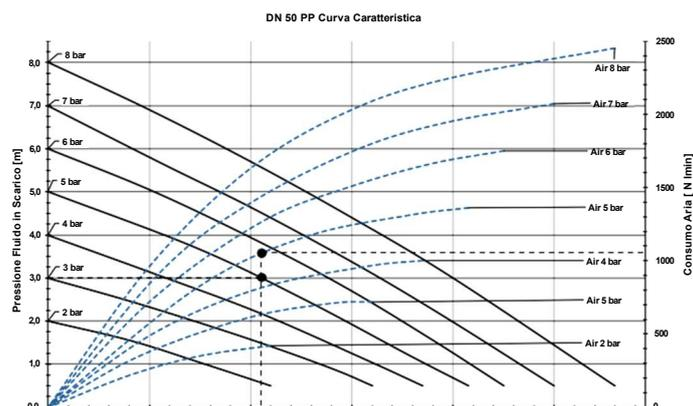
Per pompare 110 l/min ad una pressione di 4 bar, si richiedono di 8 bar di alimentazione con consumo d'aria di 820 l/min.
