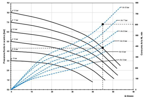
Per pompare 45 l/min ad una pressione di 4,3 bar, si richiedono di 8 bar di alimentazione con consumo d'aria di 600 NI/min.
