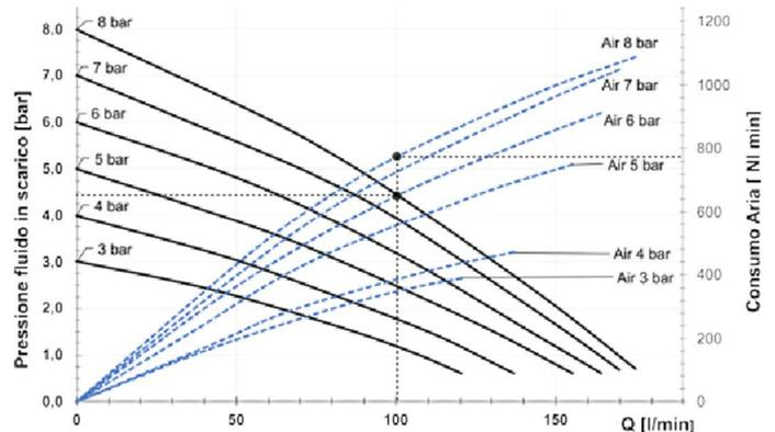
Per pompare 100 l/min ad una pressione di 4,5 bar, si richiedono di 8 bar di alimentazione con consumo d'aria di 790 NI/min.
