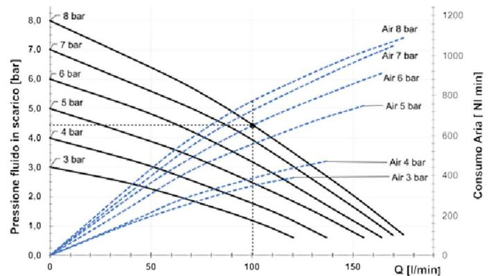
Per pompare 100 l/min ad una pressione di 4,5 bar, si richiedono di 8 bar di alimentazione con consumo d'aria di 790 NI/min.
