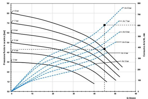
Per pompare 45 l/min ad una pressione di 4,3 bar, si richiedono di 8 bar di alimentazione con consumo d'aria di 600 Nl/min.
