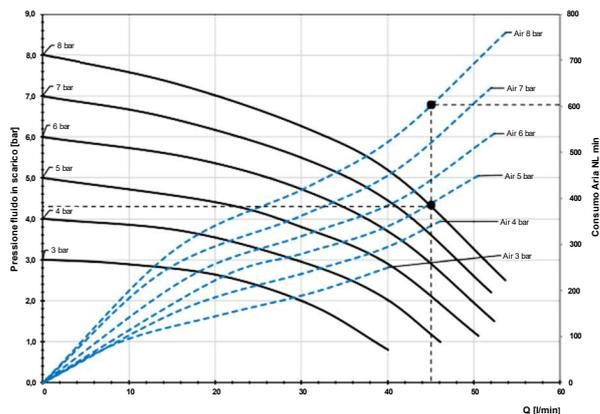
Per pompare 45 l/min ad una pressione di 4,3 bar, si richiedono di 8 bar di alimentazione con consumo d'aria di 600 Nm<sup>3</sup>/min.
