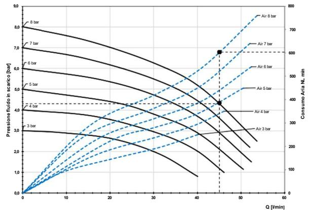
Per pompare 45 l/min ad una pressione di 4,3 bar, si richiedono di 8 bar di alimentazione con consumo d'aria di 600 l/min.
